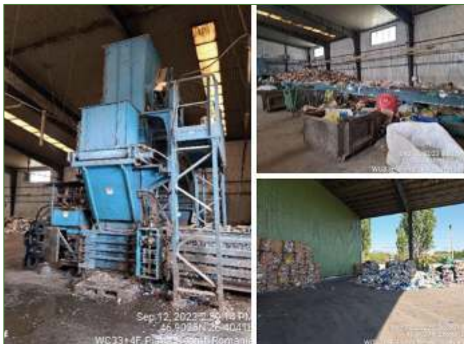
Figura 4-3 Presă balotat, bandă sortare, zonă depozitare baloți stație de sortare Piatra Neamț
