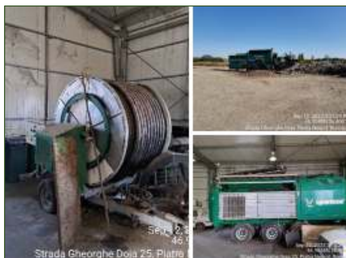
Figura 4-8 Instalație udat brazde, sită rotativă, tocător mobil Stație de compostare Piatra Neamț
